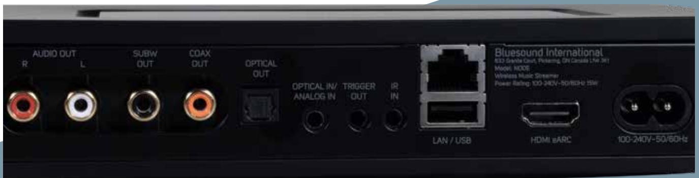
Ausreichend ausgestattet und übersichtlich ausgestaltet – Das Anschlussterminal des Node quillt nicht über, aber verfügt über das Nötigste. Die wichtigste Zuleitung besteht eh im Ethernet-Netzwerkanschluss
