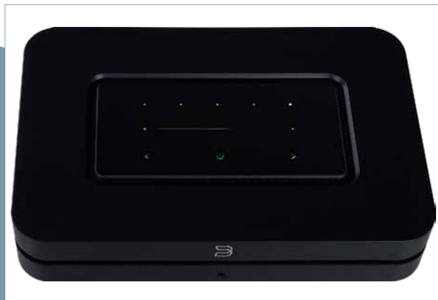
Kryptische Zurückhaltung – simple Punkte und Linien kommunizieren die Platzierung von Presets und die Lautstärkeinstellung des Node Mk II
